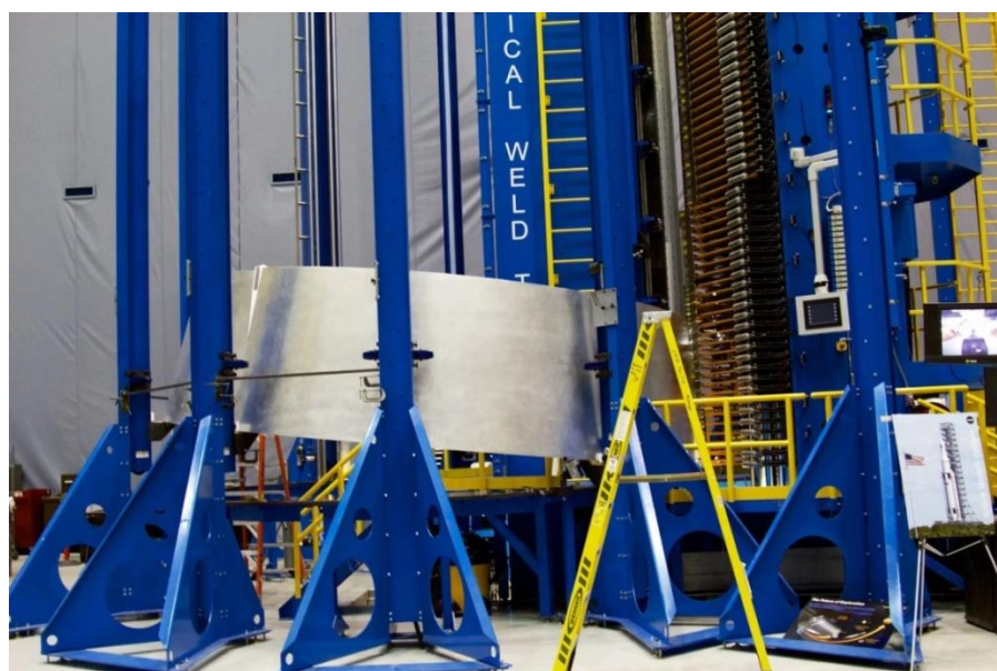
Рисунок 2. Оборудование СТП для вертикальной сварки
