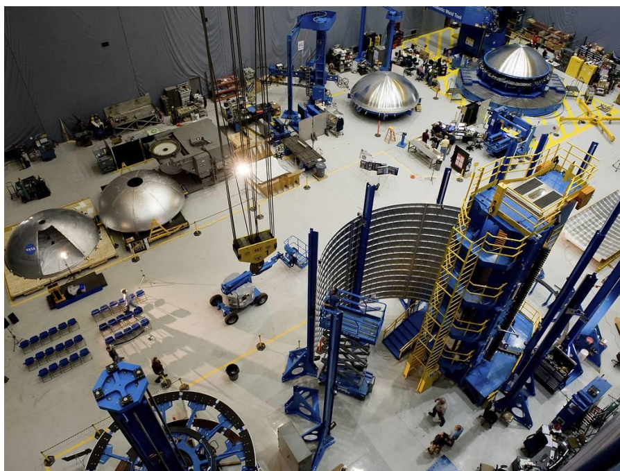
Рисунок 1. Общий вид сварочного и производственного оборудования (на заднем плане - алюминиевые днища баков, изготовленные с использованием СТП)
