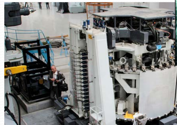
Сварочная установка KR-002 на базе специализированного оборудования портального типа
