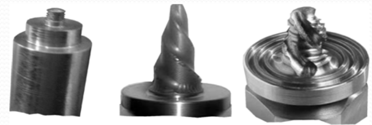
Рабочие части однооставного инструмента, применяемого для сварки трением с перемешиванием типовых конструкций:
